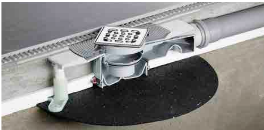
Siphon Advantix Top avec protection contre les refoulements grâce à une barrière de garde d'eau et des poches de retenue latérales.
