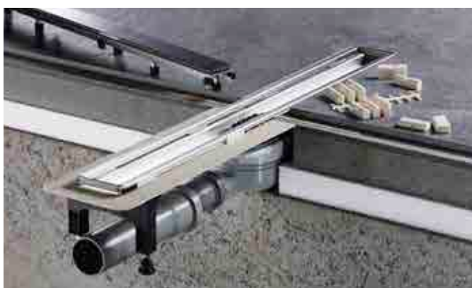
La pose parallèle sous la rigole fait que la chape n'est pas traversée par le tube de raccordement.
