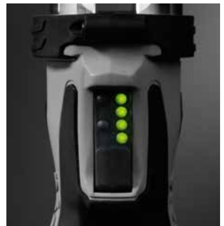
Le nouvel affichage LED indique l'état de la batterie et la connexion Bluetooth®.
